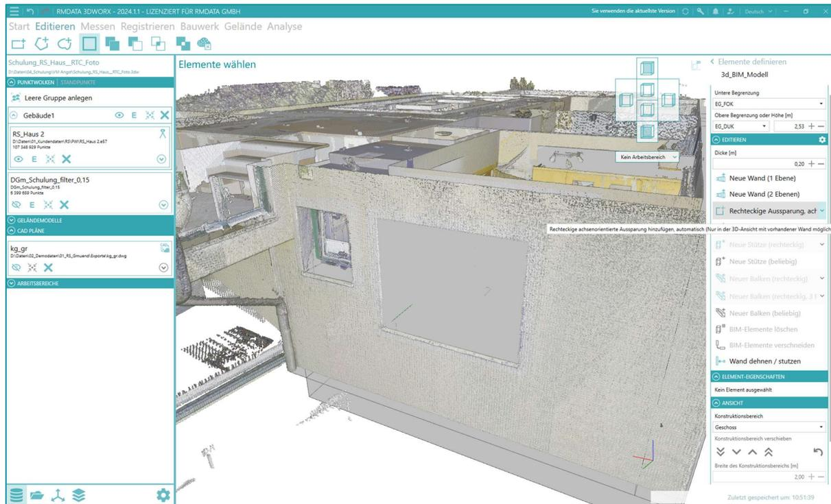
Wählen Sie z.B. rechteckige Aussparung achsenorientiert und klicken Sie in die Öffnung. Die Aussparung wird berechnet. Kann auf Grund von Störobjekten die Aussparung nicht richtig gefunden werden, definieren Sie diese wie gewohnt unter **Wand-Details bearbeiten**.
